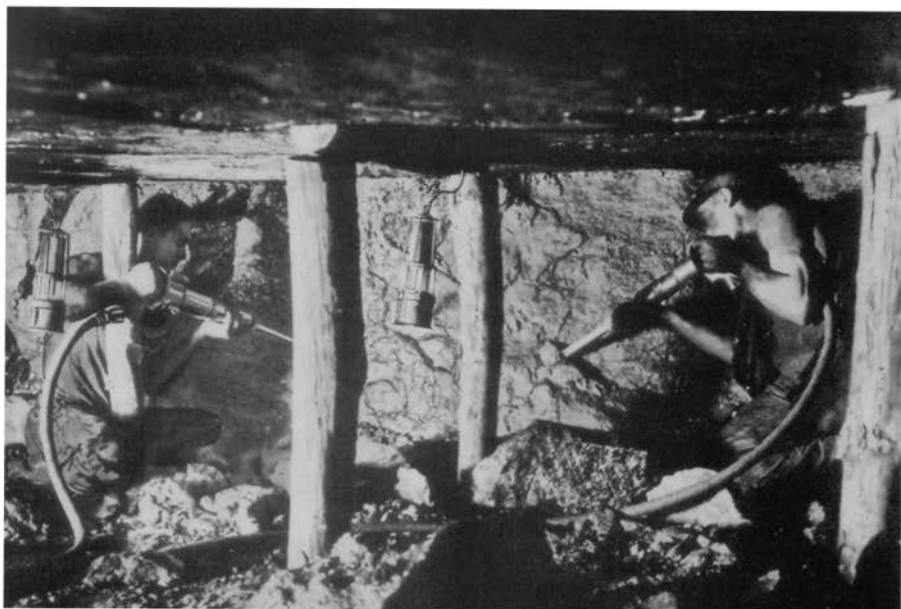
Mijnwerkers aan het werk in een pijler met een afbouwamer. De vervanging van de pikhouweel door deze pneumatische hamers zorgde voor meer gevallen van stoflongen. Vanaf midden jaren dertig ging men werken met afbouwhamers met waterinjectie om de stofontwikkeling te reduceren.
