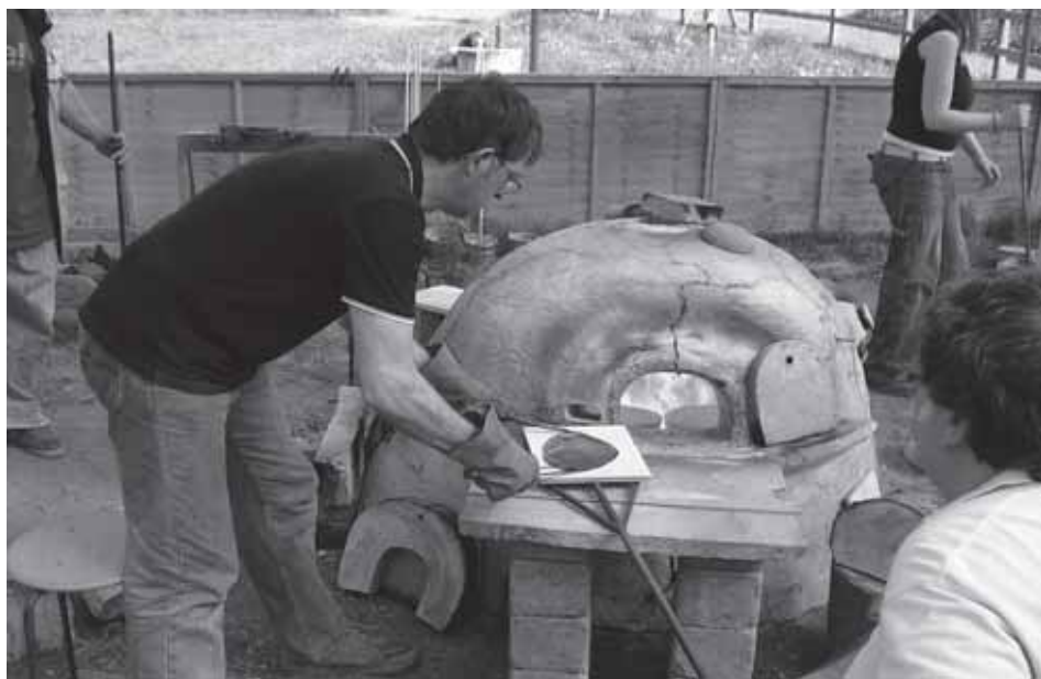
De glasplaat wordt met werktuigen uitgetrokken tot een vierkante of rechthoekige vorm. Tussendoor moet de plaat steeds worden verhit in de oven.
