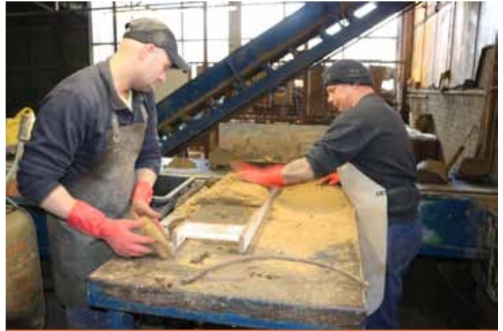
Productie tegels Klinkers: Voor de reconstructie zijn op authentieke wijze tegels van verschillende formaten geproduceerd door Klinkers uit Maastricht. Hier is de vorming van de tegels met de hand en met behulp van houten mallen te zien.
